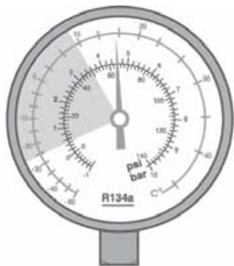
Les manomètres de basse pression et de haute pression indiquent la même valeur.
