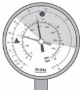
Haute pression normale (l) ou trop faible (s)
