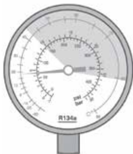
Les manomètres de basse pression et de haute pression indiquent la même valeur.
