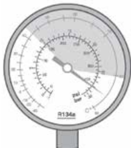
Haute pression trop élevée
