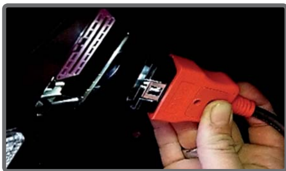
Câble de données avec LED intégrée
