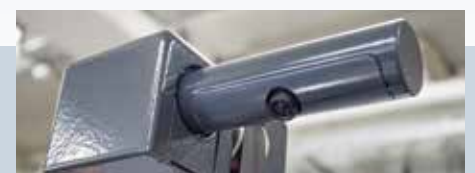
Si le MLT 3000 dispose d'une caméra d'alignement, il est alors capable de s'aligner aux éléments de carrosserie les plus saillants avec une très grande précision. Ensuite, l'alignement est évalué à l'aide d'une trame de référence qui s'affiche sur l'écran couleur livré avec le régloscope.
