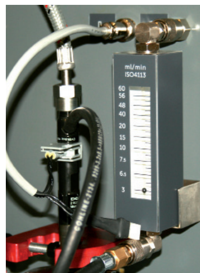
◀ En option, Delphi livre la machine YDT-35B équipée d'un dispositif de mesure de retours de fuite.
