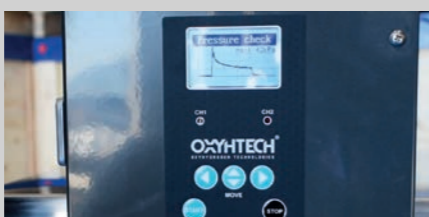
Contrôle de l'état du filtre / contrôle de la pression différentielle
