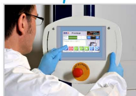
Unité de pilotage avec écran tactile intuitif
