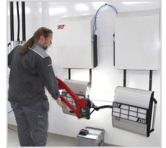
Capotage cassettes IR (rangement et protection)
